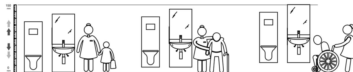
A gama completa de estruturas permite ao utilizador ajustar a altura do **sanitário** (até 15 cm) e do **lavatório** (até 30 cm), através de um comando, **aumentando a funcionalidade e o conforto** na casa de banho.
