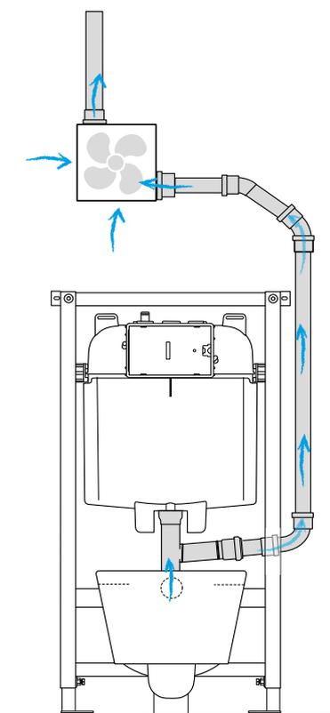
Эта система подготовлена для подключения к мощной вытяжке (в зависимости от версии: 80 или 100 м<sup>3</sup> / ч), которая, благодаря своей функции двойного вакуума, позволяет удалять неприятные запахи непосредственно из туалета через сливную трубу, в то время как конденсат удаляется через элегантную и незаметную пластину.
