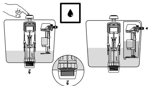
Una volta scaricata l'acqua, chiusa la valvola di scarico, il sistema ad apertura ritardata permette al galleggiante di iniziare il ricarica.
