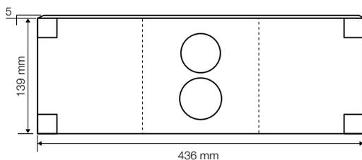
Il supporto e la placca di ispezione hanno la dimensione necessaria per sostituirsi alla placca di comando e alle piastrelle dimensione 150x150 mm poste alle estremità, garantendo l'accesso all'interno della cassetta per eventuali manutenzioni.
