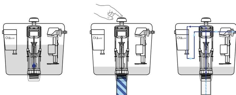
Il liquido disinfettante biodegradabile è sempre in un circuito chiuso a differenza dei metodi tradizionali, che sono sempre in contatto con l'acqua, causando danni alla cassetta e ai suoi componenti. A livello estetico è una soluzione elegante in quanto rimane nascosta all'interno della cassetta.
