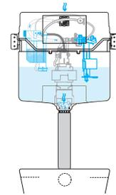
OLIpure ist ein in sich geschlossenes System, das innerhalb des Spülkastens platziert wird, wo die Reinigungsflüssigkeit gespeichert wird. Bei jeder Spülung wird das Reinigungsmittel in einer kontrollierten Dosierung (2 ml) in die Toilette abgegeben.
