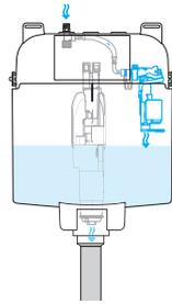
PLUS-System ermöglicht eine Wassereinsparung von bis zu 0,5 Litern bei jeder Spülung, was zu einer täglichen Einsparung von durchschnittlich 9 Litern führt.
