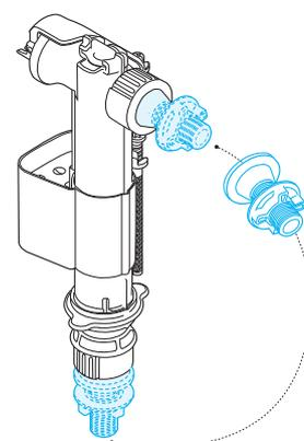
Una válvula de entrada de agua dual (inferior y lateral), sirve para entrada inferior o lateral. Instalación rápida y sencilla y de fácil mantenimiento, con un filtro superior integrado que se puede limpiar sin desconectarse de la toma de agua.
