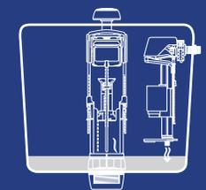
Una vez que se ha descargado el agua, la válvula de descarga se cierra y el mecanismo de retardo continúa drenando, lo que hace que la válvula de flotador se abra para llenar el tanque.
