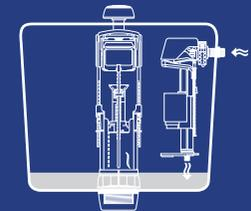
Una vez que se ha descargado el agua, la válvula de descarga se cierra y el mecanismo de retardo continúa drenando, lo que hace que la válvula de flotador se abra para llenar el tanque.
