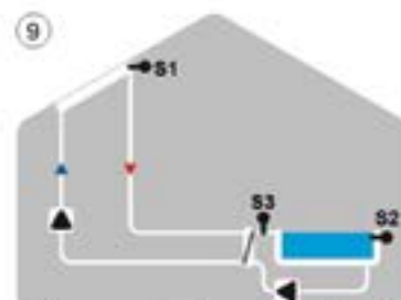
Solar com piscina e permutador de calor
