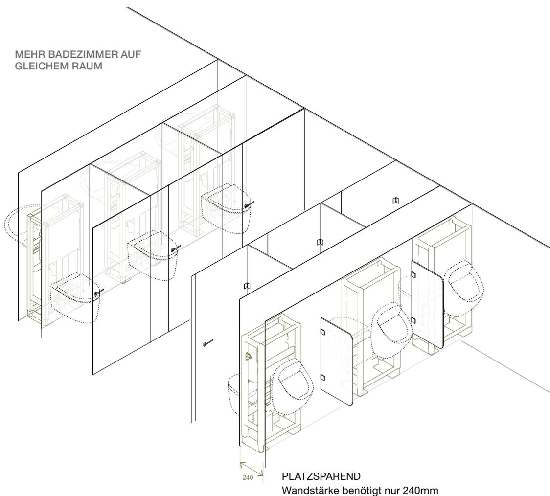
Unabhängig von der Badezimmersituation ermöglicht dieses Produkt die Montage eines WCs auf der einen Seite und – je nach gewähltem Montageset – eines Urinals oder Waschtischs auf der anderen Seite. Beide Anschlüsse nutzen gemeinsam ein Abflussrohr in Y-Form.
