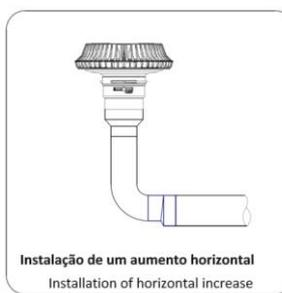
Mudanças de direção: todas as mudanças de direção devem ser preferencialmente realizadas com duas curvas a 45° em detrimento da utilização de curvas a 90°, sendo a única exceção a ligação dos ralos ao “tail pipe”.
