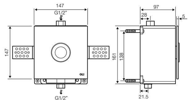
La valvola di flusso deve essere installata prima di chiudere il muro.
