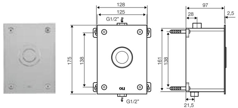
La valvola di flusso deve essere installata prima di chiudere il muro.
