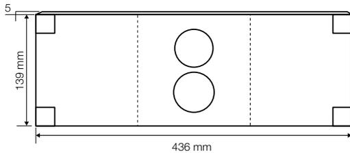
Il supporto e la placca di ispezione ha la dimensione necessaria per sostituirsi alla placca di comando e alle piastrelle dimensione 150x150 mm poste alle estremità, garantendo l'accesso all'interno della cassetta per eventuali manutenzioni.
