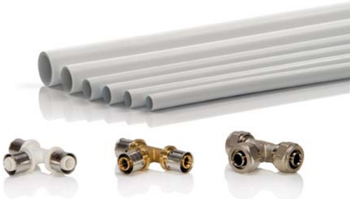
Como o Pexal®, também o Mixal® une as vantagens dos materiais sintéticos (resistência à abrasão, à corrosão e aos agentes químicos e higiene), com as do alumínio (resistência a altas temperaturas e pressões, estabilidade dimensional, impermeabilidade ao oxigénio e luz e a baixa dilatação térmica).
