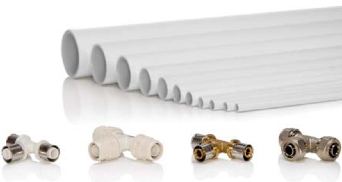
A tubagem multicamada Pexal® têm a característica de unir as vantagens dos materiais sintéticos e em particular do polietileno reticulado, tal como a resistência à abrasão, à corrosão e aos agentes químicos e higiene, com as do alumínio, entre as quais resistência a altas temperaturas e pressões, estabilidade dimensional, impermeabilidade ao oxigénio e luz e a baixa dilatação térmica.
