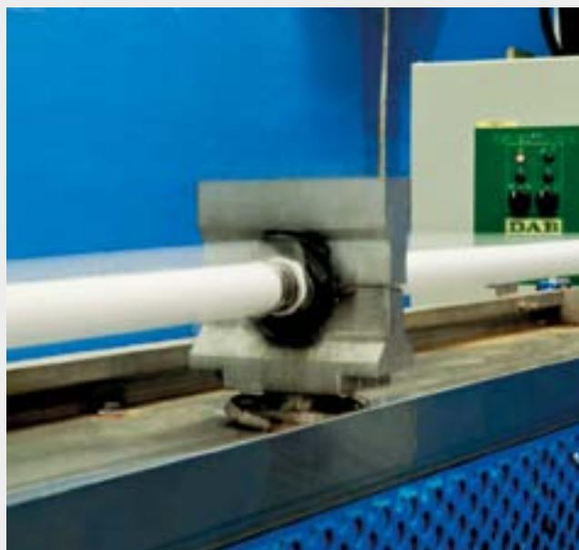
A ligação permanente do tubo é realizada por compressão mediante o apertar da porca sobre o anel de compressão.
